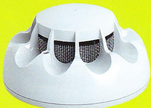
Конструкция датчика обеспечивает простой монтаж на любую поверхность. Встроенный зуммер позволяет включить локальное звуковое оповещение при обнаружении задымления. Два встроенных светодиода обеспечивают визуальный контроль параметров работы извещателя под любым углом.
