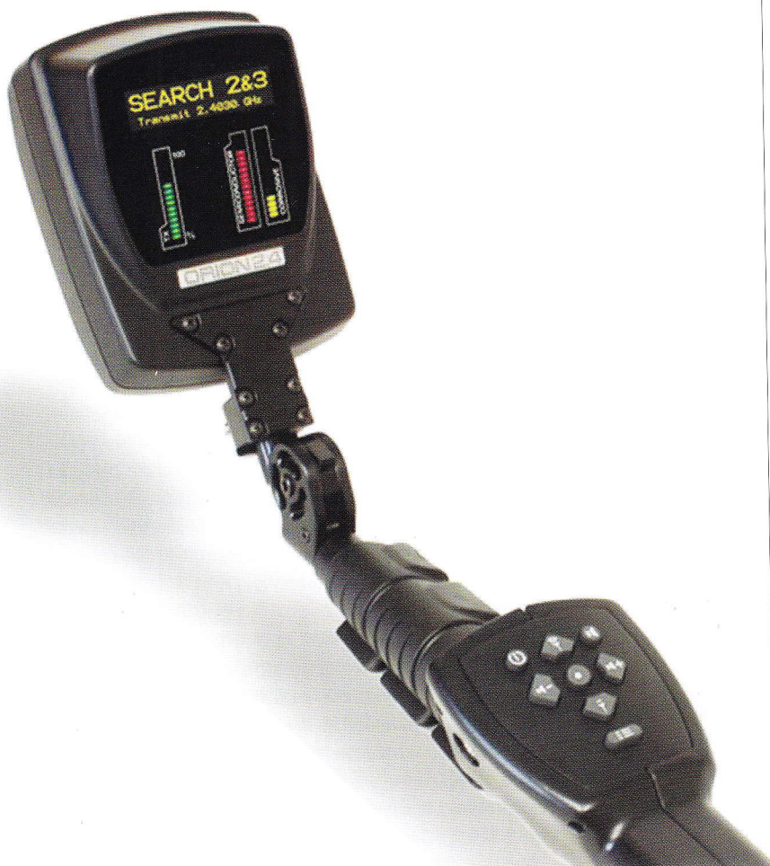
РИС. 8. ДЕТЕКТОР НЕЛИНЕЙНОСТЕЙ ORION 2.4
